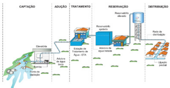
Figura 12 – Sistema de Abastecimento de Água
